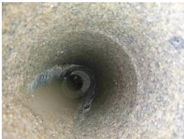
Pohled do vývrtu v patě. Viditelná struktura žuly, následuje beton.
