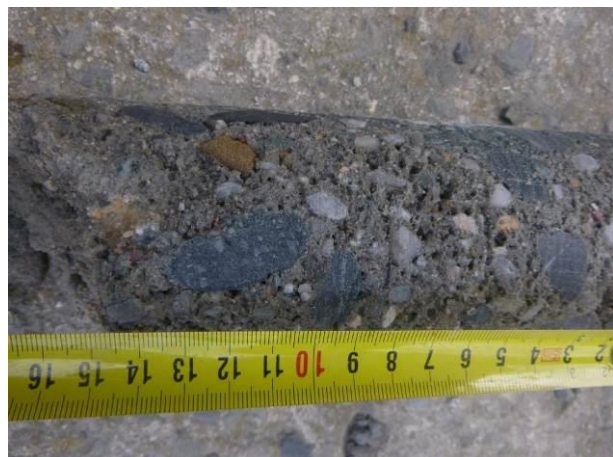
Beton byl detekován se zvýšenou pórovitostí.
