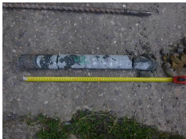
Pohled na jádro betonu ze základu. Hloubka založení byla naměřena 55 cm.
