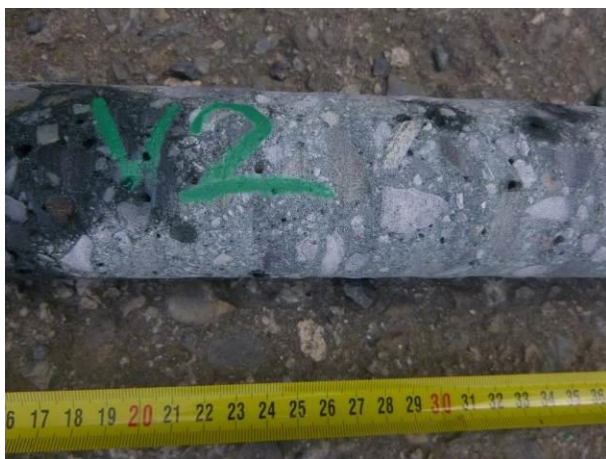
Poměrně hutná struktura betonu základu.
