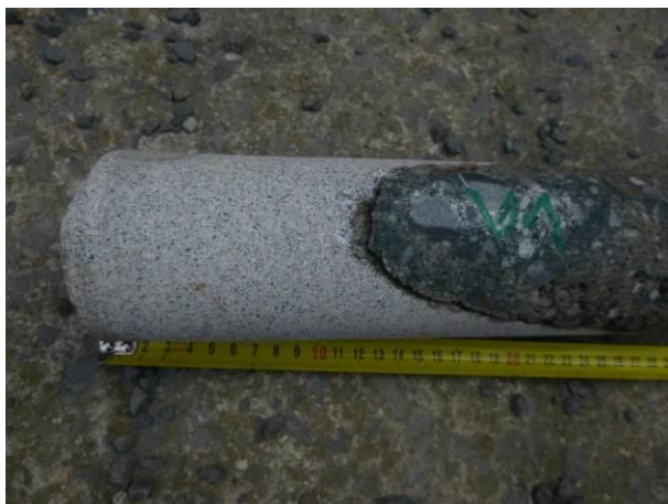
Detailní pohled na strukturu kamene a betonu.
