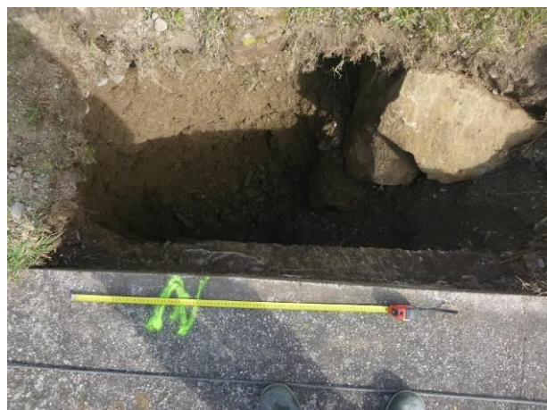
Pohled na kopanou sondu za rubem zdi v profilu p1.
